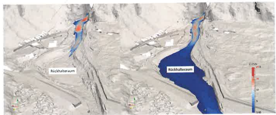
Abbildung 2: Simulation mehrerer Murgangschübe zu Beginn (links) und nach etwa 1 Minute (rechts). Blickrichtung flussaufwärts.
