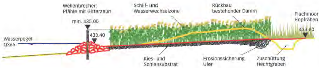
Schnitt durch das Ufer vor dem Flachmoor mit den Details des Aufwertungsprojekts: flache Ufervorschtützung und Schilfbepflanzung in der Wasserschutzzone.
