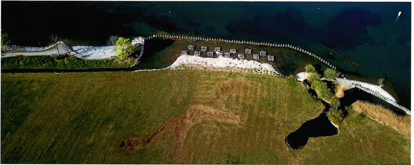
Abbildung 3: Der Blick auf den umgestalteten Projektbereich zeigt deutlich den von Süden (links) nach Norden (rechts) zunehmenden Bereich des flacheren Seegrunds, der mit Wellen interagiert. Quelle: Schelbert AG, Muotathal. Figure 3 : La vue de la zone réaménagée du projet montre clairement la zone croissante du sud (à gauche) vers le nord (à droite) du fond du lac moins profond, qui interagit avec les vagues. Source : Schelbert AG, Muotathal
